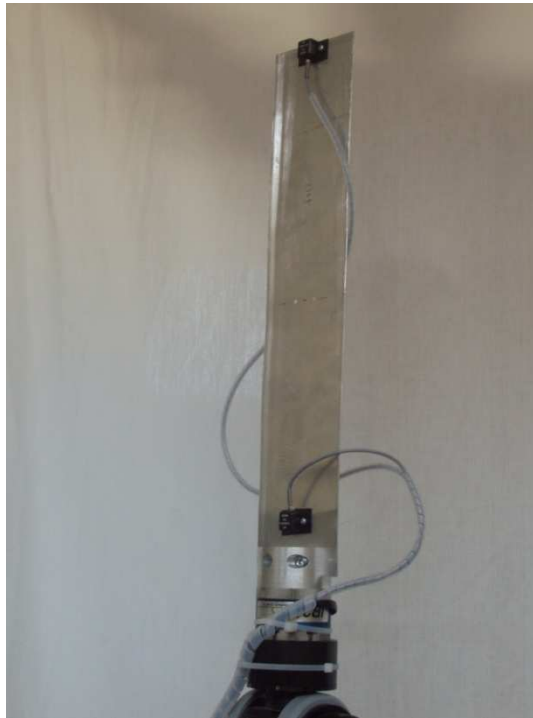
Figura 4.1 Lâmina de alumínio montada no punho do robô.
