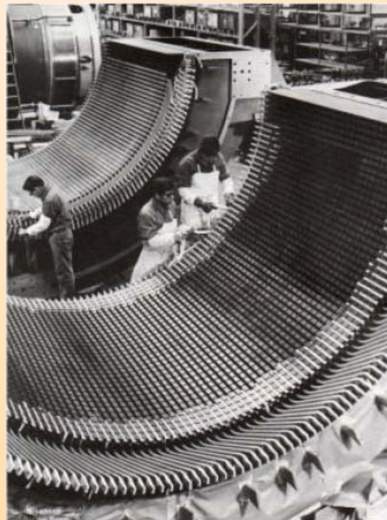
Montagem de enrolamentos no estátor de máquina síncrona (metade)
