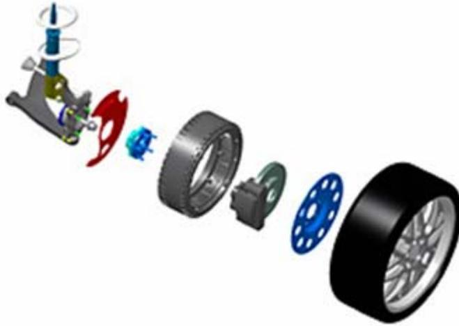
**Fig 5.** - Direct drive colocado directamente numa roda motriz de um veículo
