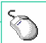
**Rato** O rato, ou *mouse* é um periférico de entrada, que serve de auxiliar ao teclado no processo de entrada de dados, especialmente na selecção de opções em programas com interface gráfica. Liga-se através duma porta série (RS232), PS/2 ou USB. Existem ratos com um, dois ou mais botões.
