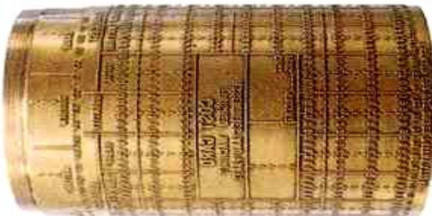
Este cilindro de impressão de três polegadas e meia pertence à primeira máquina que produziu comercialmente a alta velocidade cartões perfurados - a impressora Carroll desenvolvida pela IBM em 1924.
