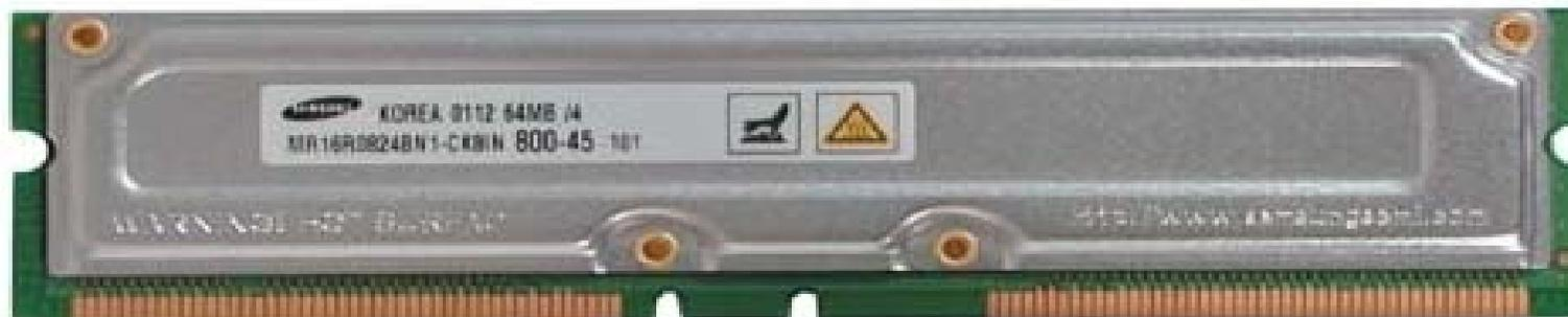
**RIMM** (*Rambus In-line Memory Module*). Este tipo de memória tem uma configuração idêntica às DIMM, usando um bus especial para incrementação de velocidade.
